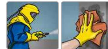
La superficie a pintar deberá limpiarse con chorro de abrasivo con grado de limpieza SSPC SP-5 o su equivalente, con un perfil de anclaje de 1.5 a 2.5 mils de plg. La humedad relativa durante la aplicación y curado deberá ser mayor a 50%.
