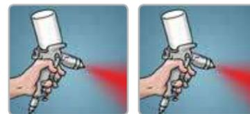
Aplique con equipo de aspersión convencional con boquilla para orgánicos de zinc. Se recomienda diluir un 10% con Adelgazador 2. Durante la aplicación cuide la vida útil de la mezcla que es de 2 a 8 horas en condiciones normales de temperatura y humedad. Utilice brocha solo para retoques y reparaciones específicas.
