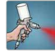
Aplicar una capa delgada y húmeda, haciendo pasadas paralelas, traslapando cada pasada en un 50%, dando especial atención a soldaduras, esquinas, etc. Permitir que el producto seque un mínimo de 10 - 15 minutos a 21 °C antes de aplicar la segunda capa.
