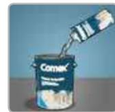
Relación de mezcla 4:1 en volumen de la resina (parte A): endurecedor (parte B). Agregar lentamente el endurecedor a la resina con agitación constante hasta lograr una mezcla uniforme. Diluir con Solvente Xilol, si es con brocha o rodillo de 3 a 5%, si es por aspersión 5%.
