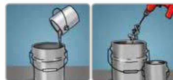
Incorpore cada uno de los componentes perfectamente en su envase original. Mezcle en volumen 4 partes de resina por 1 parte de catalizador. Incorpore perfectamente y deje reposar la mezcla 30 minutos.
