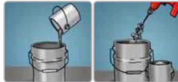
Incorporar manual o mecánicamente la base o resina en su envase original, posteriormente añadir el endurecedor a la resina y agitar hasta incorporar la mezcla por completo. Agregar el endurecedor a la resina en relación 4 a 1 en volumen hasta lograr una mezcla homogénea. Se recomienda una dilución con disolventes del 15% para la capa de sellado.
