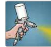
Aplicar a una sola mano únicamente con pistola de aspersión de manera uniforme sobre la superficie, dejar el espesor de película húmeda lo mas delgado posible. Dejar secar durante 30 minutos para recubrir.
