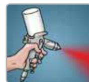
La aplicación debe hacerse cuando la superficie metálica se encuentre a temperatura mínima de 10 °C y máximo de 40 °C. Espesor recomendado de película seca por capa de 1.0 - 1.5 milésimas de pulgada.
