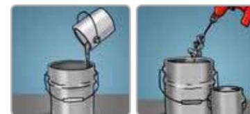
El producto se aplica con una relación de mezcla en volumen de 77 partes de Resina por 23 partes de Polvo. Para evitar grumos en la pintura, añada el polvo de zinc al líquido. Filtre la mezcla con una malla de 30-60. Agite de forma continua durante la aplicación.
