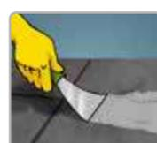
Vaciar el producto en un recipiente con salida para aplicación, llenar las juntas hasta 2/3 de su profundidad en el caso de emplear hule espuma o arena como materiales de soporte de la junta. Permitir que el producto endurezca ligeramente (45-90 min). Después, llenar completamente la junta con una segunda aplicación, permitiendo que el producto se desborde ligeramente. Una vez que la junta haya curado, cortar al ras del piso el excedente de producto con ayuda de una cuña metálica.
