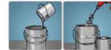
Incorporar manual o mecánicamente la base o resina en su envase original, posteriormente añadir el endurecedor a la resina y agitar mecánicamente hasta incorporar la mezcla por completo. Agregar el endurecedor a la resina en relación 4 a 1 en volumen hasta lograr una mezcla homogénea. De ser necesario, añadir el Solvente Amercoat 923 o Amercoat 65.
