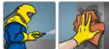
La superficie a pintar deberá limpiarse con chorro de abrasivo con grado de limpieza SSPC SP-10 o más alto, con un perfil de anclaje de 1 a 2 mils de plg. La humedad relativa durante la aplicación y curado no deberá exceder del 85%.
