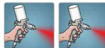
Aplique con equipo de aspersión convencional con boquilla para silicatos de zinc. Cuando se aplica a temperaturas mayores de 30°C se recomienda adicionar Thinner 90-53 en una proporción del 10%. Durante la aplicación cuide la vida útil de la mezcla que es de 8 horas en condiciones normales de temperatura y humedad. Utilice brocha solo para retoques y reparaciones específicas.
