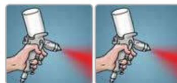
Para aplicación por aspersión puede utilizar un máximo de 5% de Thinner Amercoat 65 para temperaturas menores a 93°C, para temperaturas entre 93°C y 150°C utilice 5% de Thinner Amercoat 101. Con brocha y rodillo se puede utilizar thinner Amercoat 65 con un máximo de 5% y para aplicación en caliente utilice Thinner Amercoat 101 con un máximo de 5%.
