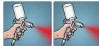
Se aplica con equipo airless o por aspersión convencional, haciendo traslapos del 50% y hasta humedecer toda la superficie. Espesor de película recomendado por capa de 3 a 6 mils. de plg.
