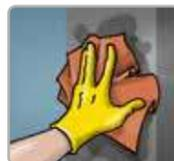
La capa previa debe ser compatible, estar seca y libre de cualquier contaminación. Si ya cuenta con un primario epóxico, se debe aplicar PSX-700 dentro del tiempo de repintado. Es posible que se requiera generar rugosidad con lija en el epóxico para asegurar la adherencia del producto.
