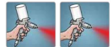
Aplice con equipo de aspersión convencional con boquilla para silicatos de zinc. Cuando se aplica a temperaturas mayores de 30°C se recomienda adicionar Adelgazador 2 en una proporción del 10%. Durante la aplicación cuide la vida útil de la mezcla que es de 5 horas en condiciones normales de temperatura y humedad. Utilice brocha solo para retoques y reparaciones específicas.
