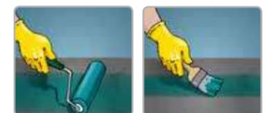
En superficies nuevas o deterioradas aplicar una mano del producto diluido 1:1 con solvente GN y dejar secar por 24 horas. Aplicar 2 manos del producto como mínimo esperando 24 horas entre mano y mano.
