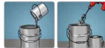
Incorpore la resina perfectamente en su envase original, posteriormente adicione el catalizador y mezcle perfectamente durante 2 minutos. Posteriormente añada el polvo de zinc con agitación constante hasta su incorporación. Filtre la mezcla con una malla de 40. Agite de forma continua durante la aplicación.
