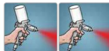
Si es necesario diluya máximo un 10% con Adelgazador 5 y homogenice perfectamente el producto. Durante la aplicación cuide la vida útil de la mezcla que es de 4 horas en condiciones normales de temperatura y humedad.
