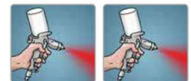
Aplique con equipo de aspersión convencional con boquilla para orgánicos de zinc. Se recomienda diluir un 10% con Thinner Amercoat 65. Cuando se aplica a temperaturas mayores de 32°C se recomienda adicionar Thinner 91-82 en una proporción del 10%. Durante la aplicación cuide la vida útil de la mezcla que es de 16 horas en condiciones normales de temperatura y humedad. Utilice brocha solo para retoques y reparaciones específicas.
