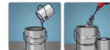
Incorpore la resina perfectamente en su envase original, posteriormente adicione el catalizador y mezcle perfectamente durante 2 minutos. Posteriormente añada el polvo de zinc con agitación constante hasta su incorporación. Filtre la mezcla con una malla de 30-60. Agite de forma continua durante la aplicación.
