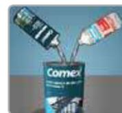
Medir una parte de catalizador por dos partes del esmalte. Agregue lentamente y con agitación constante el catalizador al esmalte hasta lograr una mezcla uniforme. Deje reposar la mezcla de 10 a 15 minutos antes de aplicar. Diluir con Solvente PT-231 hasta un 20% con pistola y 15% con brocha en caso de ser necesario.
