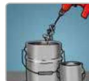
Antes de utilizar mezclar constantemente hasta que el material este perfectamente homogeneizado. Utilizar un agitador tipo Jiffy.
