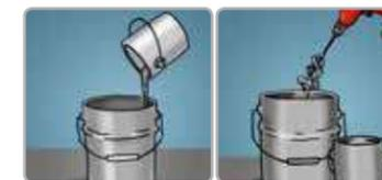
Agitar este producto, añadir 1 parte en volumen del componente A y mezclar continuamente hasta que la mezcla se homogenice.
