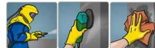
Si se aplica directo a metal, la superficie debe estar limpia, libre de óxido, pintura envejecida y presencia de corrosión. Si ya cuenta con un primario epóxico, se debe aplicar Amershield dentro del tiempo de repintado. Es posible que se requiera generar rugosidad con lija en el epóxico para asegurar la adherencia del producto.
