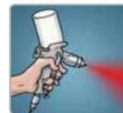
Aplicar siempre películas húmedas, en pases paralelos y traslapados en un 50%. Si se requiere, realice una aplicación cruzada en un ángulo recto para evitar la formación de poros y áreas desnudas.
