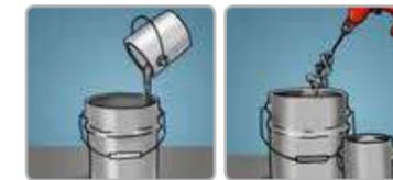
El producto se aplica con una relación de mezcla de 4.5 kgs de Polvo por 4.5 L de Líquido. Para evitar grumos en la pintura, añada el polvo de zinc al líquido. Filtre la mezcla con una malla 40. Agite de forma continua durante la aplicación.
