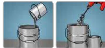
El producto se aplica con una relación de mezcla en volumen de 81 partes de Resina por 19 partes de Polvo. Para evitar grumos en la pintura, añada el polvo de zinc al líquido. Filtre la mezcla con una malla de 30-60. Agite de forma continua durante la aplicación.
