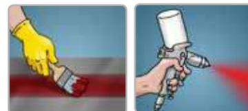
En caso de condiciones severas, se recomienda aplicar a dos manos con brocha o pistola de aspersión el Primario epóxico de alto poder anticorrosivo, dejando secar 8 horas entre mano y mano. Esperar 24 horas y aplicar el esmalte a dos manos con brocha o pistola de aspersión, dejando secar de 4 a 5 horas entre cada una.
