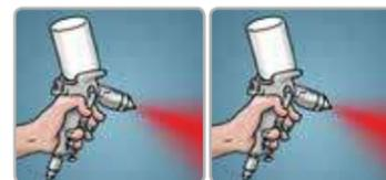
Se recomienda diluir máximo un 5% con agua limpia y homogeneizar perfectamente el producto. La adición de más agua puede afectar el secado del producto. Utilice equipo de aspersión, brocha o rodillo en su aplicación.
