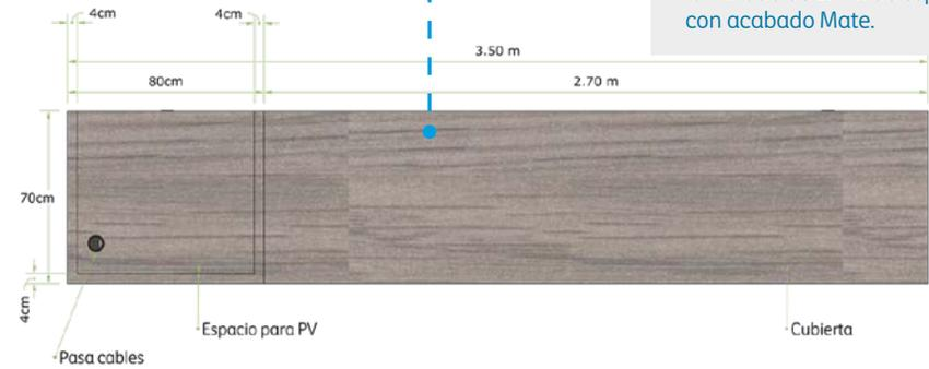
Cubierta superior, laterales y cantos de barra, forrados con Formaica Country OAK 1463 laminado de 1mm de espesor, con acabado Mate.
