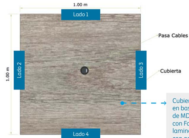
Cubierta de mesa realizada en bastidor de pino, con tapa de MDF de 15mm y Forrada con Formaica Country OAK 1463 laminado de 1mm de espesor con acabado Mate.
