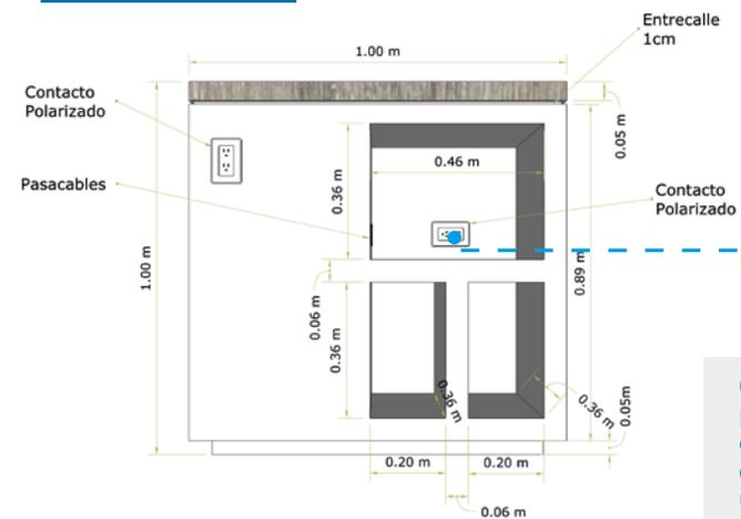
Colocación de contactos polarizados, tierra física, contactos de 3 polos y cableado con cable de uso rudo.
